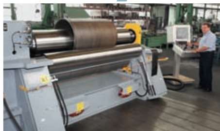
Ширина листа 2 100 мм, толщина стенки 26 мм
