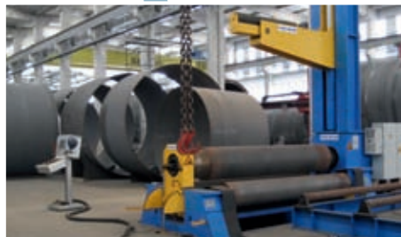
Ширина листа 3 000 мм, толщина стенки 60 мм
