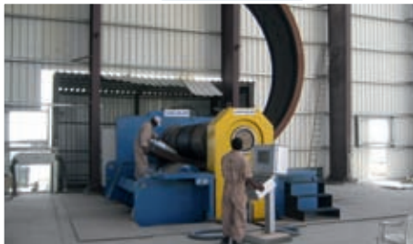
Ширина листа 3 000 мм, толщина стенки 170 мм
